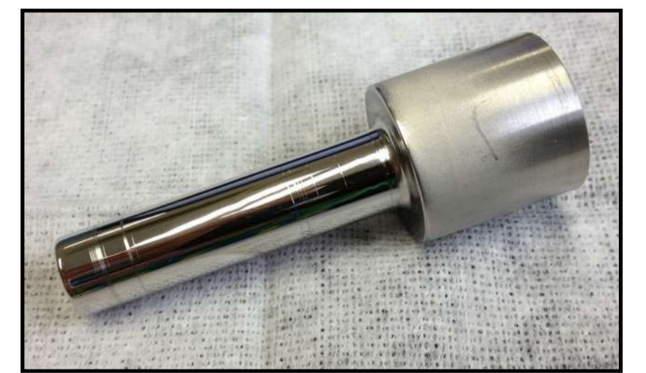
■ 観察対象のステンレス丸棒 複合研磨仕上げ
